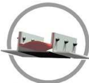
Kovový usměrňovač toku přivařený z jedné strany k potrubnímu kanálu (tvaru kužele nebo jehlanu)
